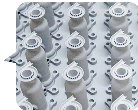
Массовое производство сложных деталей за один цикл печати
